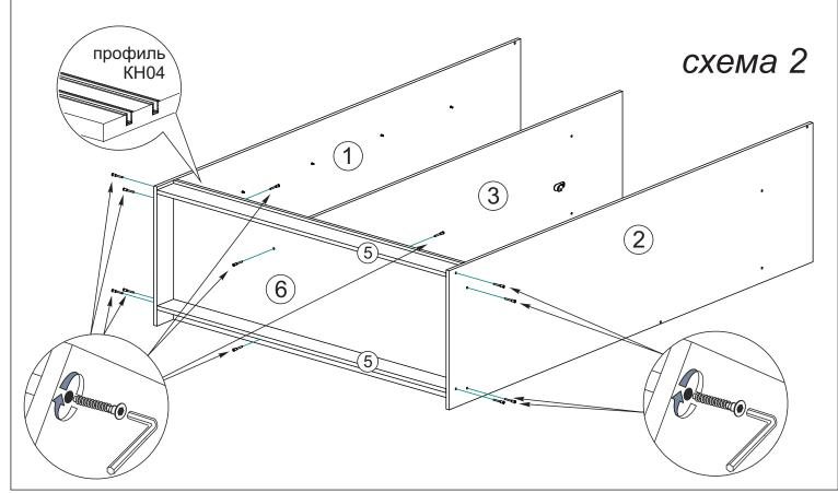
4. Соберите каркас шкафа. Для этого к боковине №2 и перегородке №3 закрепите евровинтами вязку №7 и планку №9, затем к боковинам №1 и №2 планку №10. Далее на боковины №1 и №2, а также перегородку №3 и планку №10 установите крышку №4 с прикрученной
