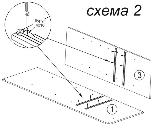
3. Присоедините к вязке №7 с помощью евровинтов цоколя №11. При помощи шурупов 4x16 закрепите на крышке №6 и вязке №7 направляющие Prestige согласно наметкам, установите в направляющую на вязке №7 фиксаторы (по одному на дверь, см. схему 3). Присоедините к вязке №7, с помощью евровинтов, боковины №1 и №4, перегородки №2 и №3.
