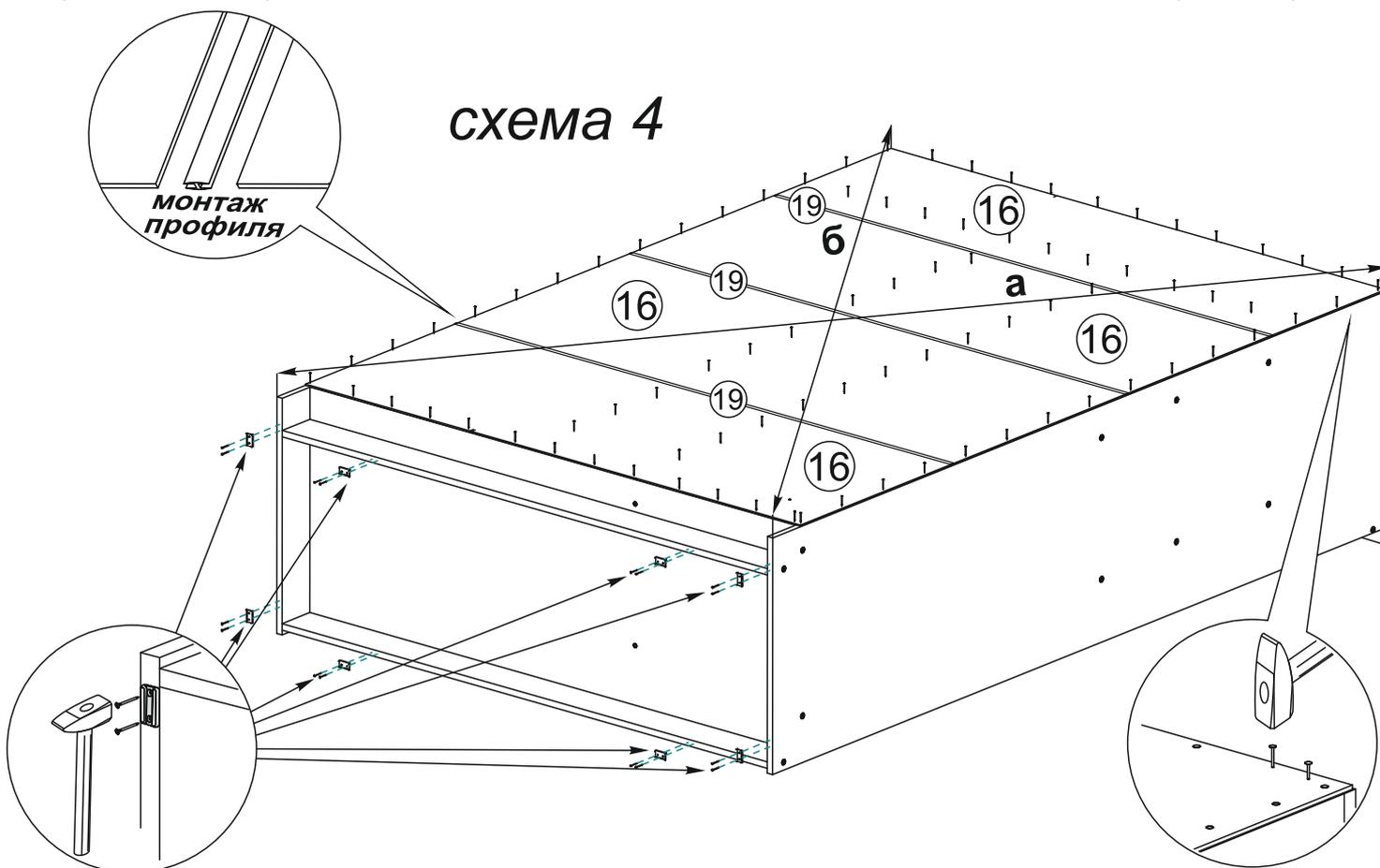
6. Далее прикрепите с помощью евровинтов к боковине №1 и перегородкам №№3,4 вязки №9, а также перегородки №5 к крышке №6 и вязке №8. Установите металлическую овальную трубу №18, как показано на схеме 5.
