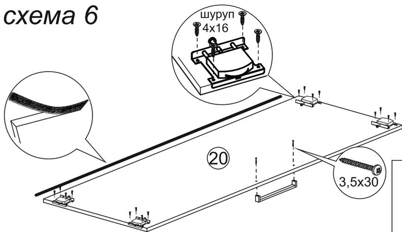
8. Собранную створку установите на направляющие в шкаф, как показано на схеме 6а. Сначала вставьте верхние ролики в направляющую на крышке №6, затем нижние ролики в направляющую на вязке №7. Каждая створка устанавливается в отдельную канавку.
